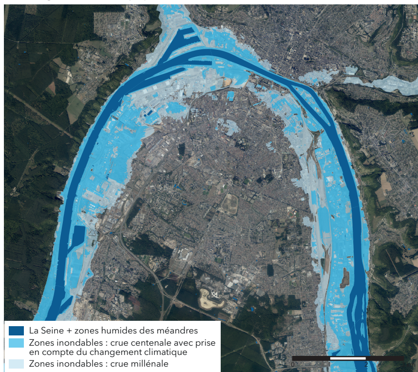
Modélisation des zones inondables par crues centennale (avec prise en compte du changement climatique) et millénaire de la Seine dans la boucle de Rouen
